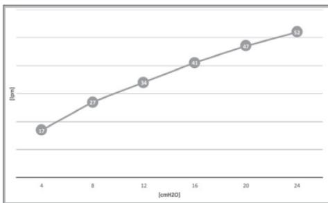
\*Datorită diferențelor de prelucrare, fluxul de ieșire din orificiile de dispersare poate varia ( $\pm 10\%$ ).
